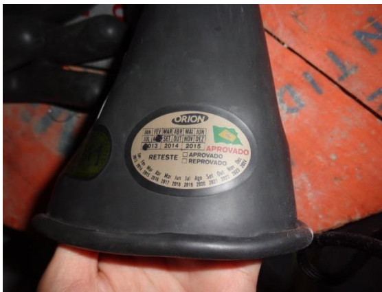
Figura 22 – Luva isolante com certificado vencido
